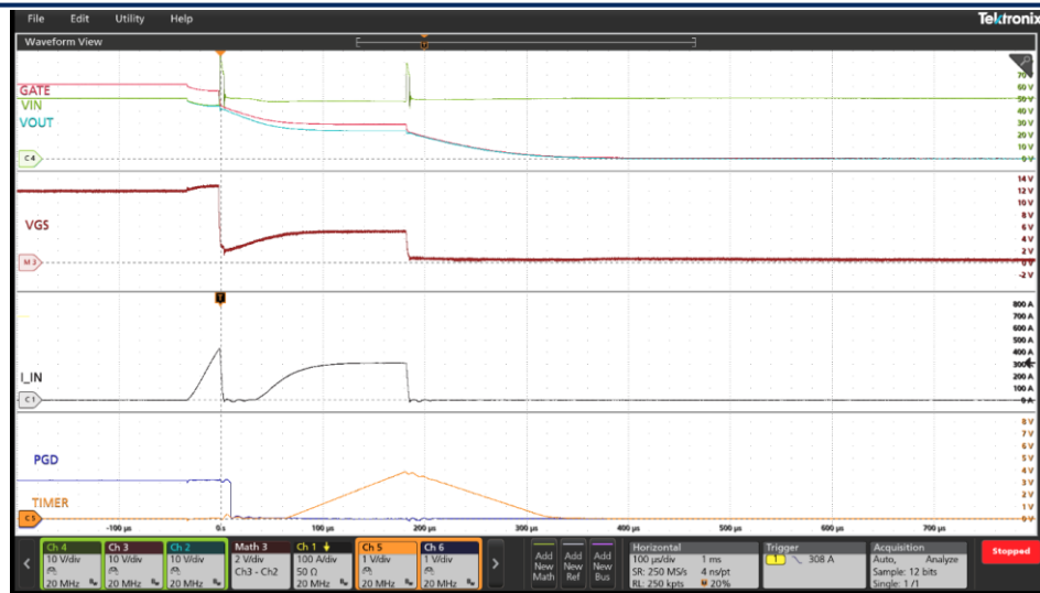
图 12. 在 CB 保护动作结束后， RTQ1954S-TA 将允许 MOSFET 再次导通（不进行电流限制）；若短路状况仍存在，OCP2 或 OCP3 会启动保护。为快速关闭 MOSFET，TIMER 脚位的电流提升至 25\mu\text{A} 。自动重试功能关闭，输入电压变为 V_{IN} = 50\text{V} 。
