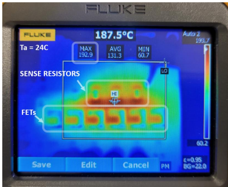
图 14. 仅具备单级过流保护 ( I_{LIM} = 300A ) 的其他热插拔控制器发生软短路及潜在故障的示例。在 285A 电流下持续 4 分钟后，MOSFET 外壳温度达到 180^{\circ}C 。
